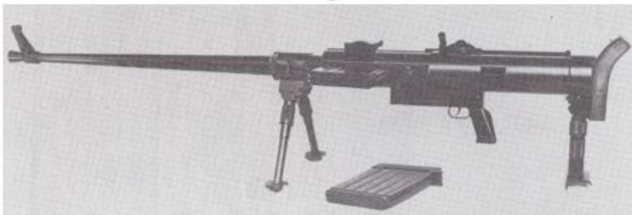
Come dicevamo le munizioni per questi fucili furono le 20mm , ma per il primo modello (SSG) si tratta della 20x72RB , mentre per il secondo modello (SSG-36) si preferì la 20x110RB
