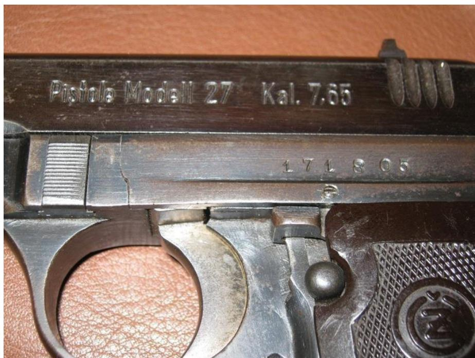
canna ed è dotata di una sua asta guidamolla a tutta lunghezza. La leva di sicura blocca cane e catena di scatto e si inserisce abbassando l'apposita leva posta sul fianco sinistro dell'arma sopra al grilletto. Per disinserirla bisogna schiacciare il pulsante posto sotto di essa.
